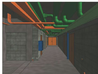
Figure 25. Identification des collisions entre réseaux (© Artelia).
