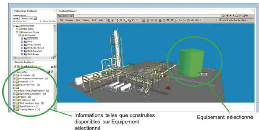
Figure 78. Plate-forme Internet d'accès aux informations contenues dans la maquette numérique telle que construite (© Jacobs).
