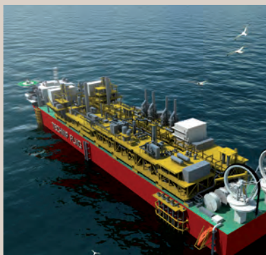
L'unité flottante de liquéfaction du gaz naturel.
