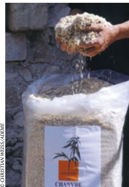
Sac de chanvre. Ce bio-matériau isole murs et planchers des habitations.
