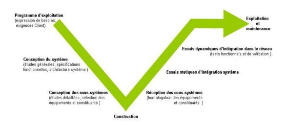
Elle doit permettre l'intégration système (cycle en V) incluant notamment :
