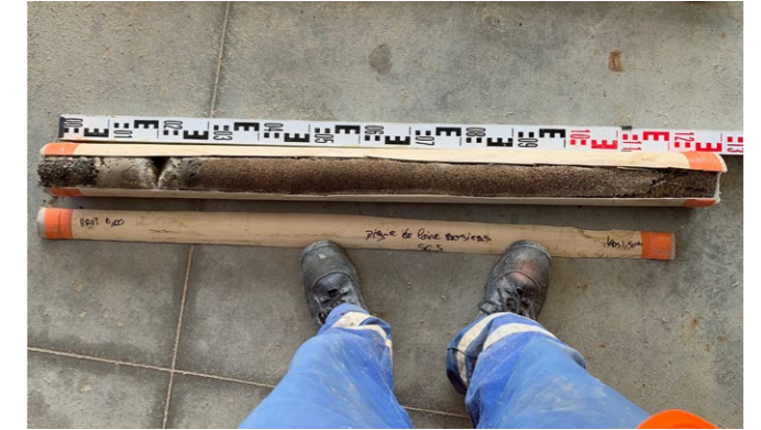
Retour des carottes prélevées au laboratoire Ginger CEBTP : prise des photos et description des carottes avant analyse
