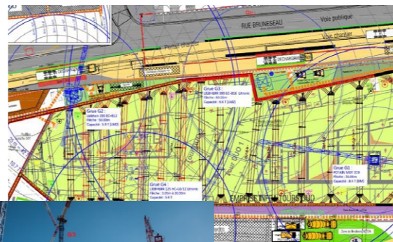
Plan d'installation de chantier
